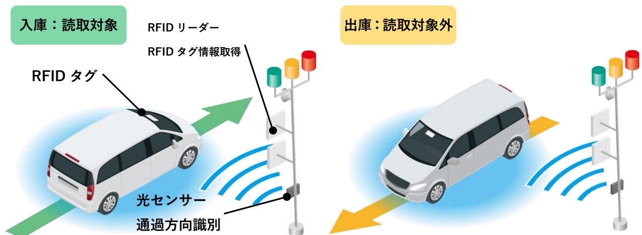
入庫台数管理を行う際の「車両通過検知システム」のイメージ
