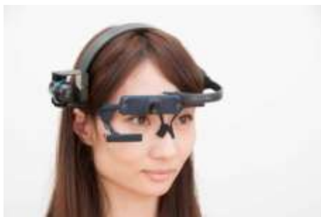
▲視線計測装置および感性計測装置を装着して実験
