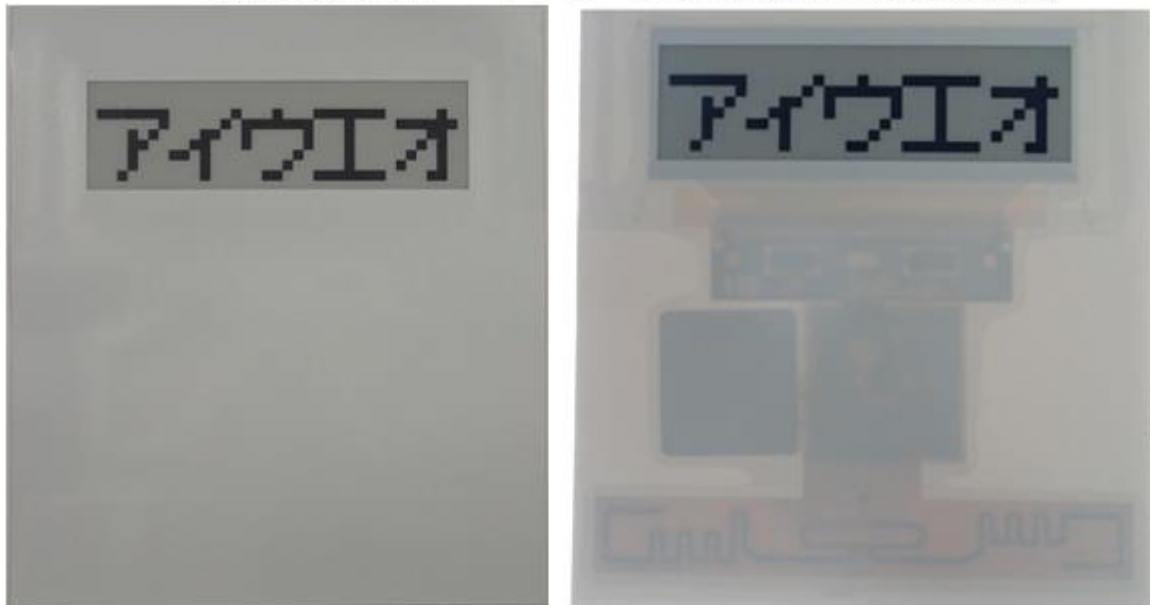
UHF帯対応の電子ペーパーラベルの開発品(右は透過光撮影)
